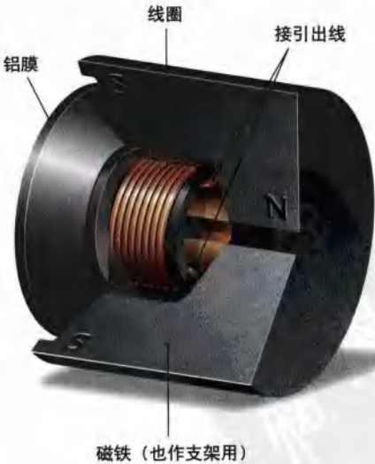
图25-3 在这个动圈式麦克风的示意图中，铝膜与磁场中的一个线圈连接在一起。当声波使膜振动时，线圈就在磁场中运动，从而产生与声波成正比的电流。
