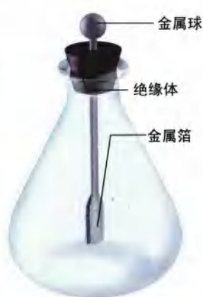
■ 图20-6 验电器是用来检验电荷的仪器。当验电器尚未带电时，两片金属箔自由下垂，几乎靠在一起。
