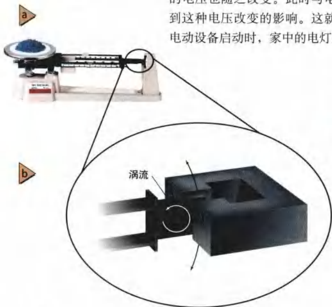
■ 图25-10 灵敏天平利用涡流阻尼控制天平臂的摆动(a)。当臂端的金属片在磁场中运动时，金属片中将产生电流。该电流继而产生一个磁场，它将阻碍电流的运动，从而阻碍天平臂的摆动(b)。
