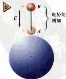
图21-5 移动物体需要克服重力做功(a)，移动电荷需要克服电场力做功(b)。在这两种情况下，物体的势能均有所增加。
