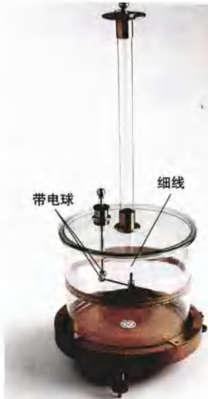
图20-10 库仑利用该装置测量了A球和B球之间的作用力。同时,他还研究了改变A、B两球之间的距离时球A的偏转情况。
