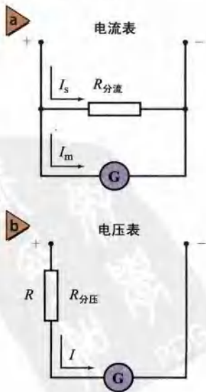
■ 图24-19 灵敏电流计可改装成电流表(a)，也可改装成电压表(b)。
