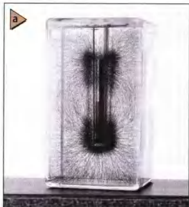
■ 图24-4 将磁铁悬挂于放有铁屑的甘油中，便可清楚地观察到三维空间中条形磁铁周围磁场的分布情况(a)。而较之更为方便的方法是将撒有铁屑的纸放在一根条形磁铁上面，这样就可以显示出磁场的二维图象了(b)。
