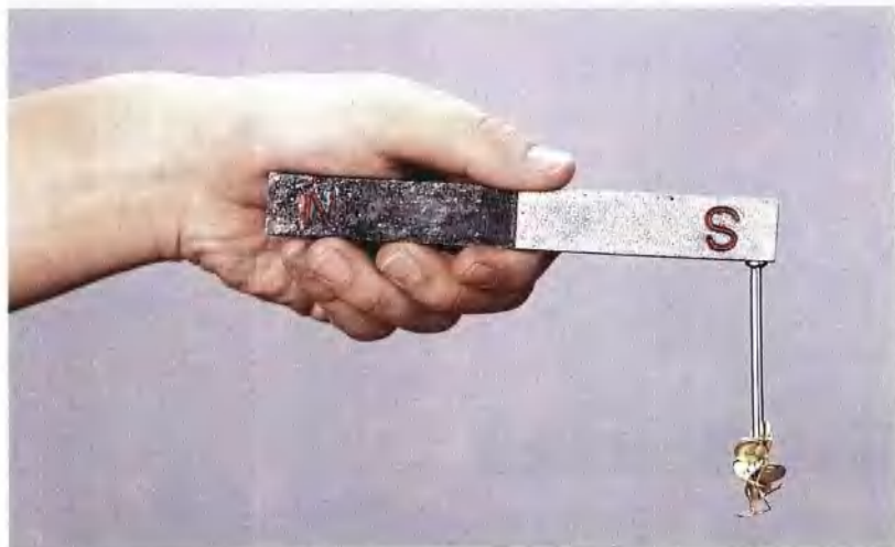
■ 图24-3 普通铁钉可被磁铁所吸引。在此过程中，铁钉有了磁性，这一点可从接触磁铁的铁钉能够吸引其他金属物件上看出。不过，如果将磁铁移开，那么这枚铁钉将失去部分磁性，原本被吸在铁钉上的一些物件就会掉落下来。
