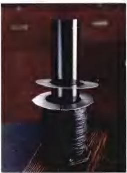
■ 图25-11 闭合的金属环中将感应出电流，而有开口的环中不存在感应电流。
