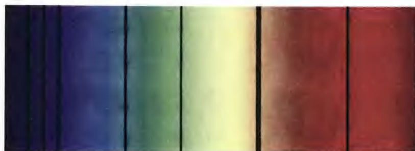
■ 图28-5 夫琅和费谱线存在于太阳光的吸收光谱中。由于太阳中各种元素的含量不一，因此有些线条比较灰暗，有些则非常暗。
