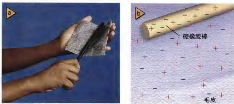
■ 图20-3 在用毛皮使硬橡胶棒带电的过程中，一些电子从毛皮转移到了硬橡胶棒上。通过这种方式，两者都变成了带电体。
