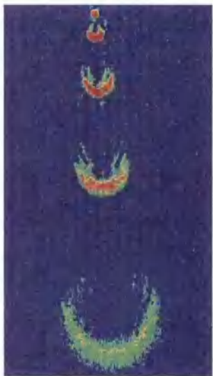
一台原子激光器发射出相干的钠原子脉冲。每一脉冲包含有 10^5 \sim 10^6 个原子。因为受到重力的作用，脉冲加速向下传播。脉冲的扩散是因排斥力引起的。
