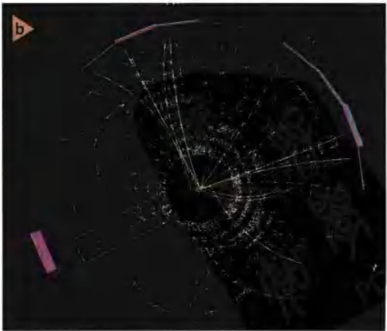
图30-14 费米实验室的对撞机探测器（CDF）可以从几十亿次碰撞中记录踪迹(a)。(b)中所示为一幅显示顶夸克事件的CDF计算机影像。
