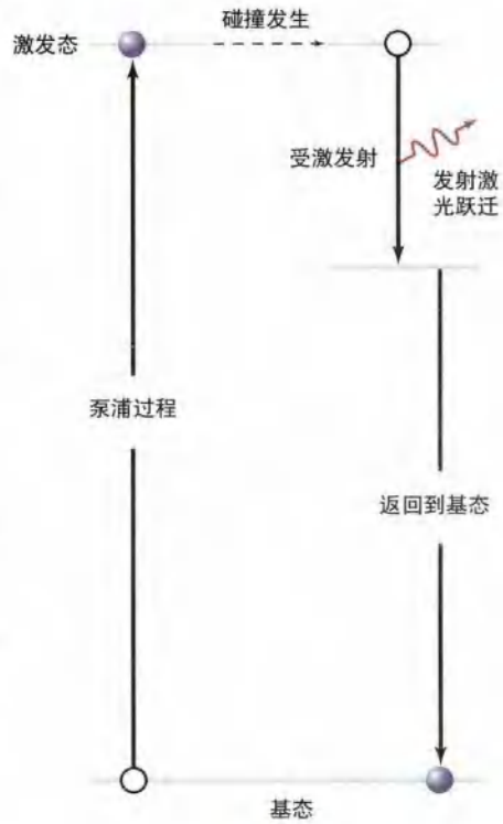
■ 图28-17 当光子与受激原子发生撞击时，光子将激发原子发射出第二个相干光子，并使原子跃迁到一个较低的能级上。
