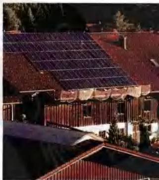
■ 图27-5 房屋上的太阳能电池板利用光电效应把太阳能转换成了电能。
