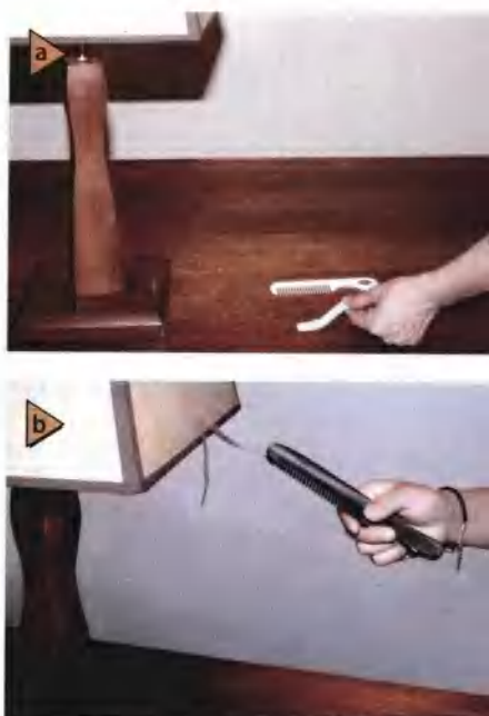
■ 图20-2 两条胶带可以带有异种电荷(a)，因此它们可用来演示同种电荷与异种电荷的相互作用(b)。
