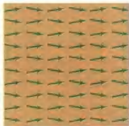
图24-14 当铁(a)变成磁铁时，它的磁畴方向变为一致(b)。
