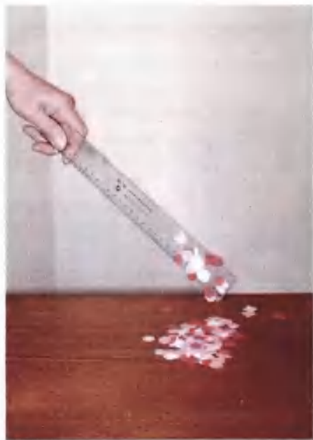
■ 图20-1 用毛皮摩擦过的塑料尺对小纸屑产生了吸引力。当这把尺靠近纸屑时，这个吸引力就会使纸屑克服重力而向上做加速运动。
