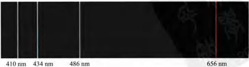
■ 图28-7 在可见光范围内，氢的发射光谱中有4条谱线。
