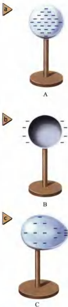
■ 图21-13 导电球上的电荷均匀地分布在它的表面(a)。空心球上的电荷全部均匀地分布在它的外表面上(b)。不规则形状的导体上的电荷在尖端处较密集(c)。
