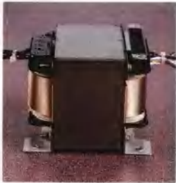
图25-14 如果输入电压与左边匝数较多的线圈连接，这台变压器就是降压变压器；反之，如果输入电压与右边线圈连接，这台变压器就是升压变压器。
