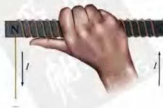
■ 图24-12 可用第二类右手定则判断电磁铁的极性。
