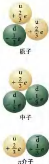
■ 图30-16 尽管夸克带有分数电荷，但是它们组成的全部粒子都带有整数电荷。
