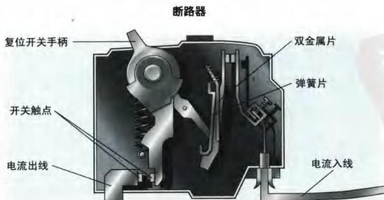
■ 图23-9 当有过大的电流通过双金属片时，它就会发热，从而引起弯曲并与弹簧片脱开。于是，开关手柄跳向断开位置，触点分开，电路切断。
