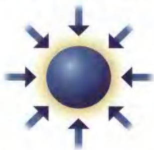
在惯性约束中， 由来自激光的光束或X射线束迅速地使小球的表面加热，形成一个周围等离子体的包围圈。剩余的核燃料被表面材料排放的热压缩。
